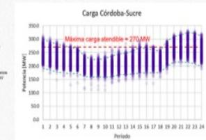
**Alto valor de carga transformadores de Chinú 1, 2 y 3 500/110 kV en condición de red completa.** A junio de 2023 se tiene un ESPS por sobrecarga de uno de estos transformadores con el que se comanda DNA para mitigar la salida de toda la subárea.
